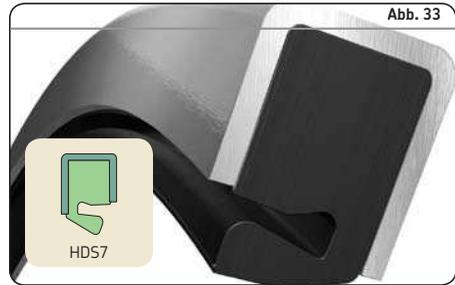
Dichtung HDS7 mit verbessertem Abdichtverhalten im Sortiment (→ **Abb. 33**). Sie wurde für fettgeschmierte Lager in Walzwerken entwickelt, wo Wasser und Kalk eine kontinuierliche Gefahr für die Lagergebrauchsdauer darstellen. Die Dichtung HDS7 eignet sich auch für großvolumige Getriebe, Kohlemühlen und Zement-schleifer. Kunden bestätigen, dass die HDS7-Dichtung leichter einzubauen ist und länger hält als ähnliche DichtungsbaufORMen.
