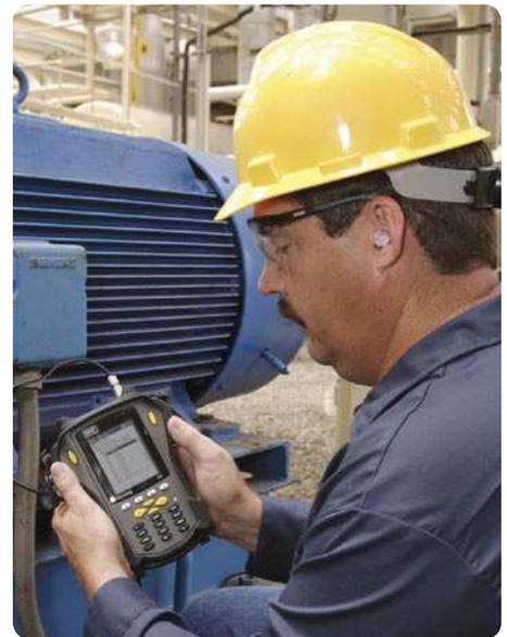
*Schwingungsmessung mit Hilfe des SKF Microlog Datensammlers/-analysators*
