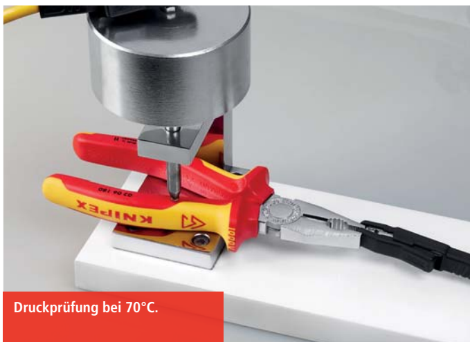
Prüfung der Haftfähigkeit der VDE-Hüllen mit 500 N.
