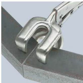
42 14 280 Greifbacken aus warmfestem Guss-Stahl; spannt nebeneinander liegendes Profil- oder Flachmaterial beim Schweißen; auch für Profile mit Stegen bis zu 25 mm Höhe
