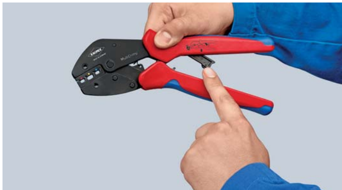
Service-Hebel einklappen und Zange durchdrücken – bereit für den nächsten Einsatz
