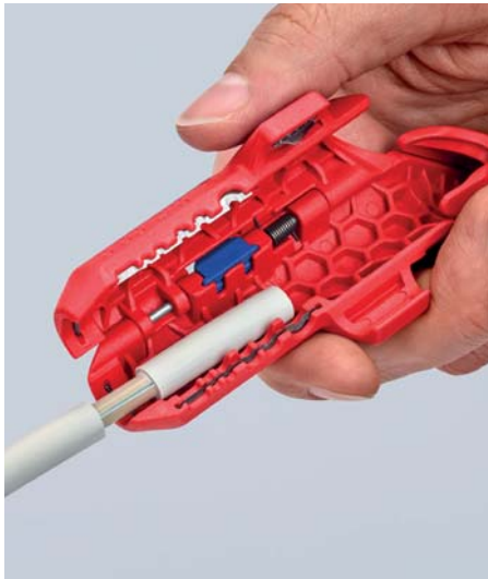
Abmanteln eines NYM-Kabels
