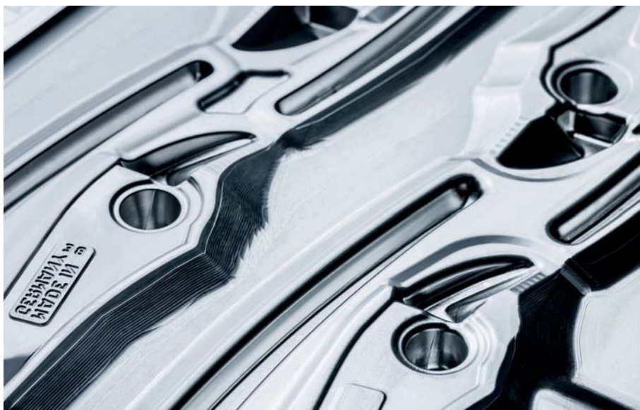
Schmiedegesenk für den Kraft-Seitenschneider mit angeschmiedeter Gelenkachse.
