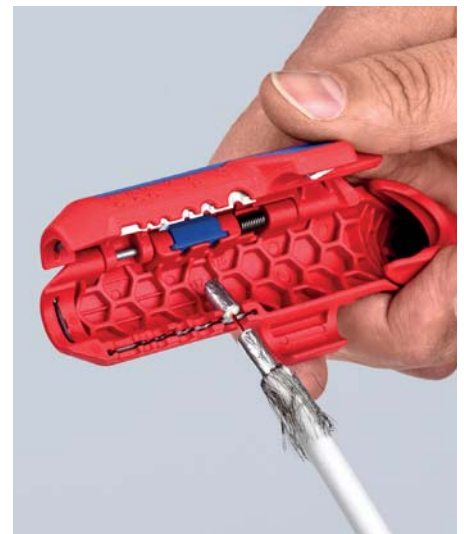
Abisolieren eines Koax-Kabels
