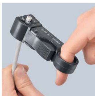
Dreistufiger Schnitt in einem Arbeitsgang
