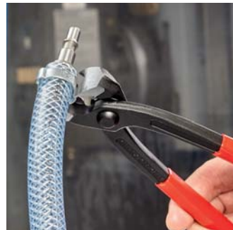
Abdichten Pneumatikschlauch an Schnellkupplung mittels der Front-Pressnase
