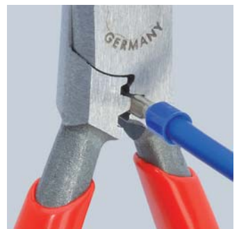
Crimpen 0,5 bis 2,5 mm 2
